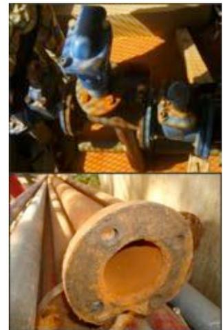
Effets corrosifs sur les colonnes de forages
